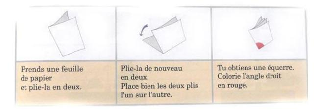
Le pliage permet de fabriquer un substitut d'une équerre et faire un angle droit
