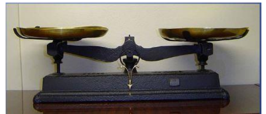
La balance de Roberval utilisée avec des poids
