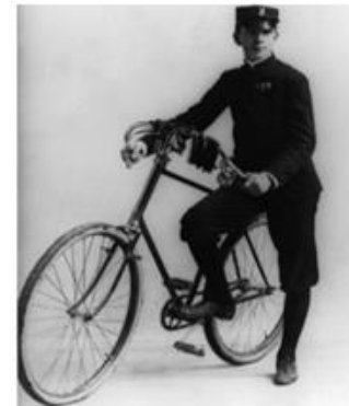
La bicyclette mise au point au XIXe siècle Deux roues de même taille et surtout des pédales et une chaîne.
