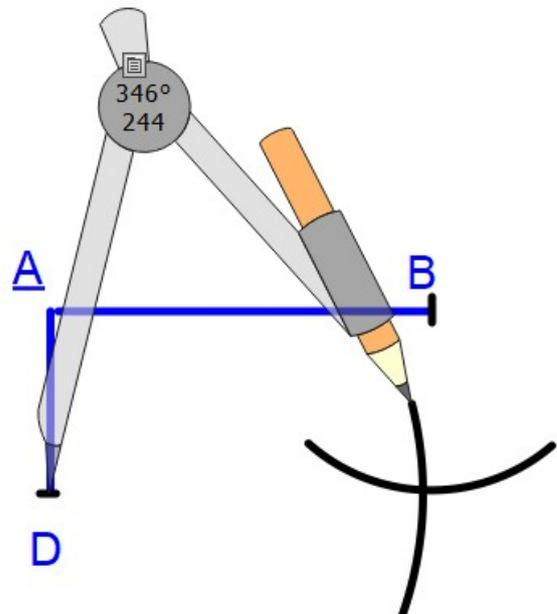
5) Pointer sur l'extrémité de la largeur, D, puis tracer l'autre arc de cercle
